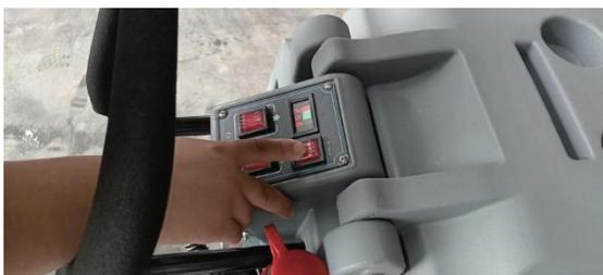
Шаг 3: включите основной переключатель питания и нажмите на кнопку включения щеточной пластины и кнопку включения всасывающего двигателя.
