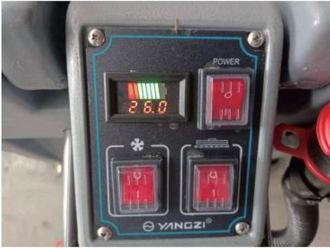
После включения основного переключателя питания вольтметр будет отображать значение напряжения батареи. Если напряжение ниже 21 В, пожалуйста, зарядите батарею перед использованием.
